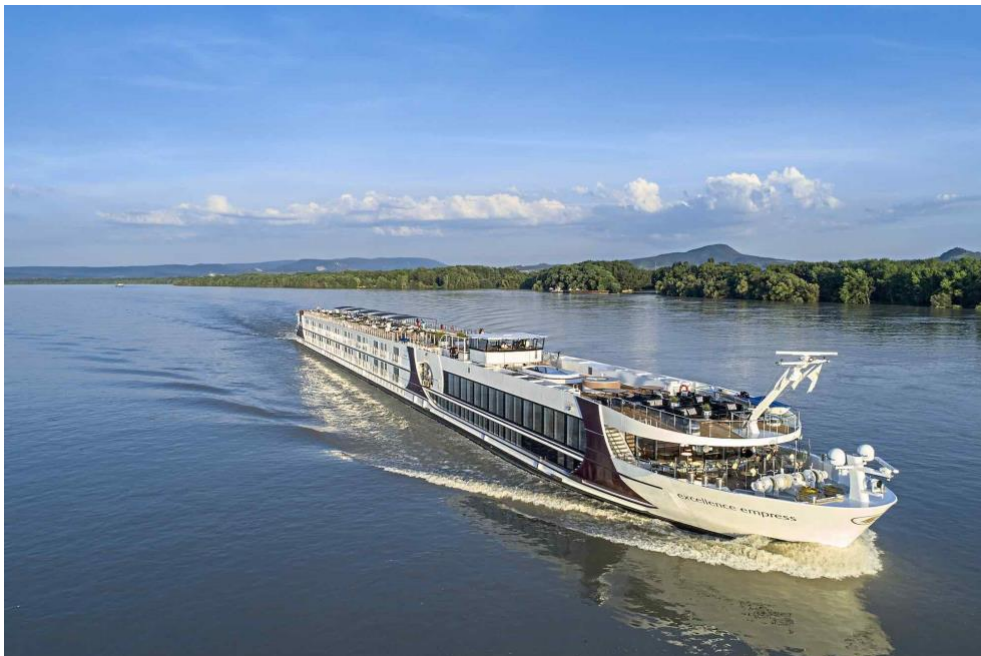
Die Excellence Empress verfügt als erstes Flussschiff der Welt über Clean Air Technology, dank der 75 Prozent des Stickoxids (NOx) und über 90 Prozent des Feinstaubes nicht mehr in die Atmosphäre gelangen. (Bild: Twerenbold Reisen Gruppe)
